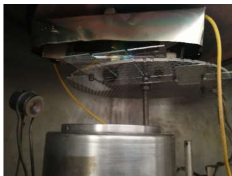
شکل ۱: موقعیت نمونه‌ها و ماده هدف در دستگاه کندوپاش.
